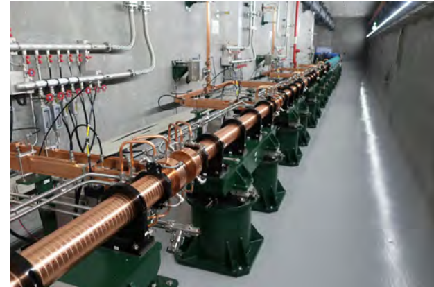
3 GeV C-band (5.7 GHz) 加速器 (40 of 2m長-空洞)
