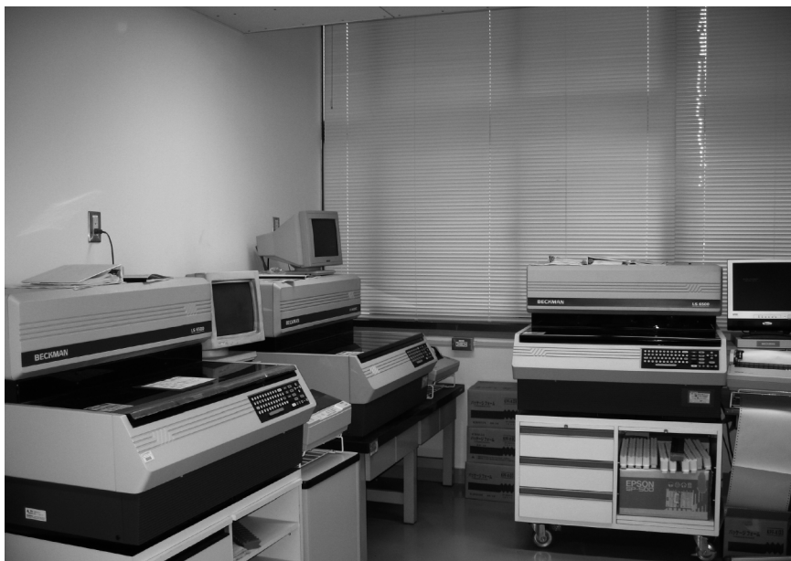
図 1. 薬学研究科 RI 施設測定室。液体シンチレーションカウンタが 3 台設置されている。
