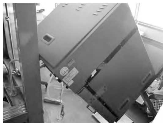
図 4. 傾いて激突した CO 2 インキュベーター
