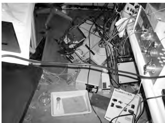
図 3. 落下した HPLC&UV デテクター
