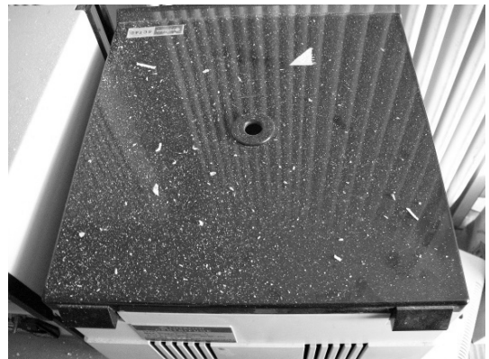
図5. 天井が歪みずれた給気ダクト (左) と装置に積った天井から降下した塵 (測定室)
