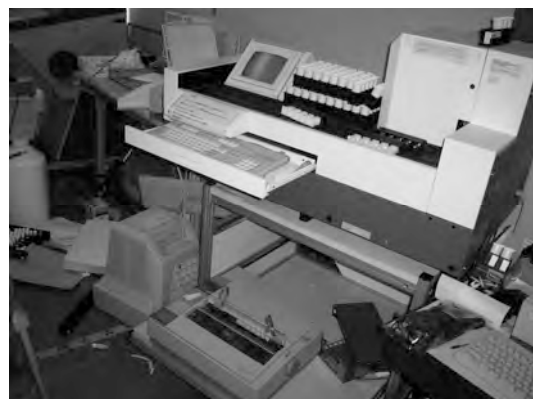
図 2. 破損したガンマカウンター
