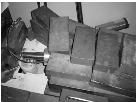
図 1. 遮蔽用鉛ブロックが落下した Ge 検出器
