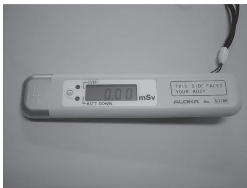
写真 2. 中性子線用の電子式ポケット線量計
