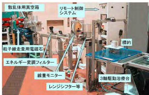
図 2. 水平照射型の基礎研究用粒子線治療
